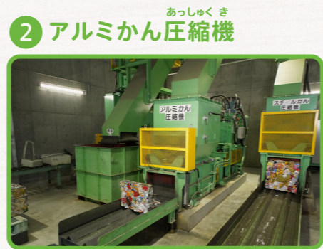
せんべつ 選別したアルミかんを機械で押しつぶしてかたまりにします。
