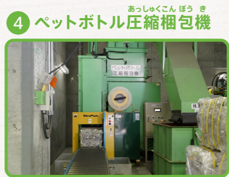
せんべつ 選別したペットボトルを機械で押しつぶしてかたまりにします。
