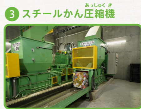
せんべつ 選別したスチールかんを機械で押しつぶしてかたまりにします。
