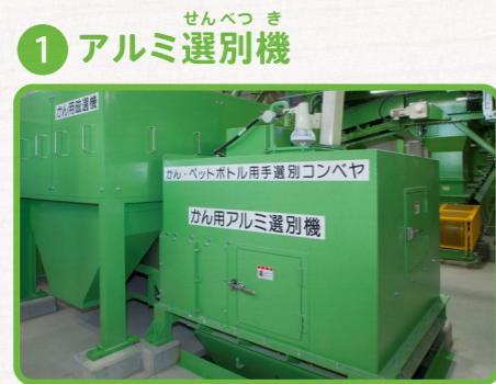
じりよく はんぱつ りよう せんべつ 磁力の反発を利用してアルミを選別します。
